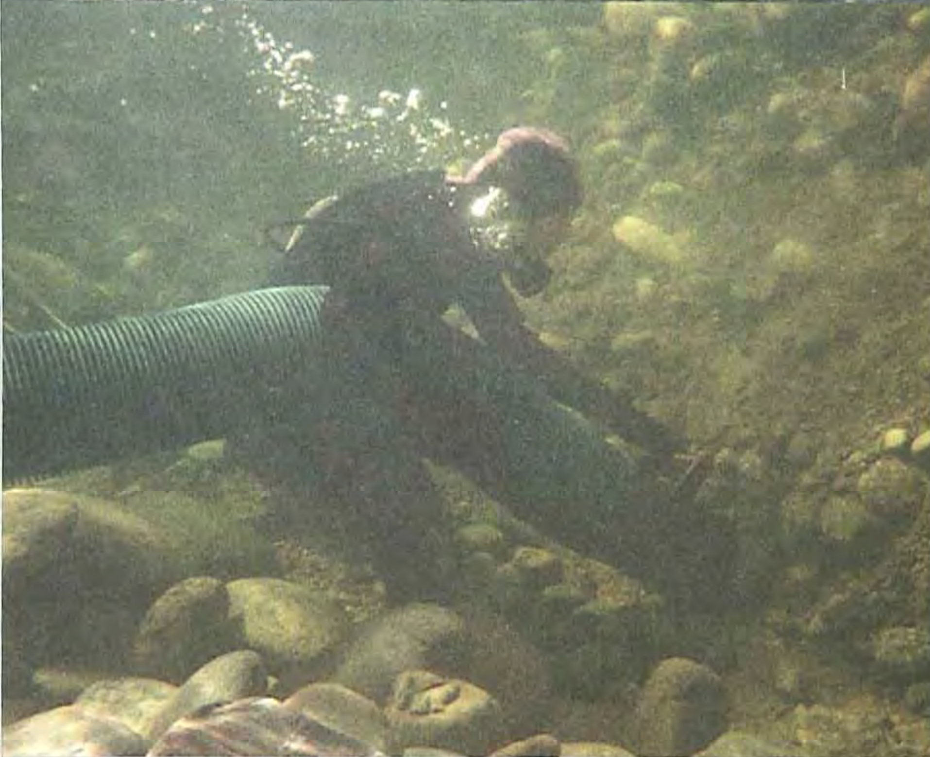
Um mit dem Schlauch lohnende Stellen abzusaugen, muss im Grey-River bis zu 2,5 Meter tief in den Flussgrund gegraben werden.
